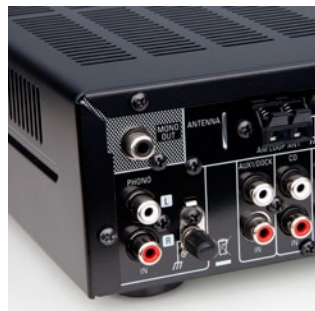
▲ Denonin vahvistimen takaa paljastui yllättäen liittäntä levysoittimelle. Tämä on erittäin harvinaista näin edullisissa vahvistimissa. Liitäntään voi kytkeä MM-rasiolla varustetun levysoittimen.
